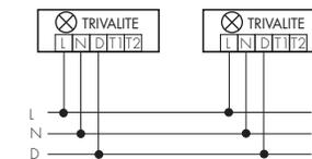
Für die Kommunikation zwischen mehreren Leuchten braucht es lediglich den Datendraht «D» (Bus-Topologie). Die maximal zulässige Länge des Datendrahtes «D» ist 1 km.
