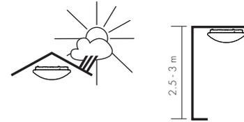
Leuchte wenn möglich an einem geschützten Ort montieren. Bei einer Wandmontage empfehlen wir eine Montagehöhe von ca. 2,5 bis 3 m. Bei der Wahl des Montageortes auf freie Sicht achten, da Infrarot-Strahlen keine festen Gegenstände – auch keine Glasscheiben – durchdringen können.
